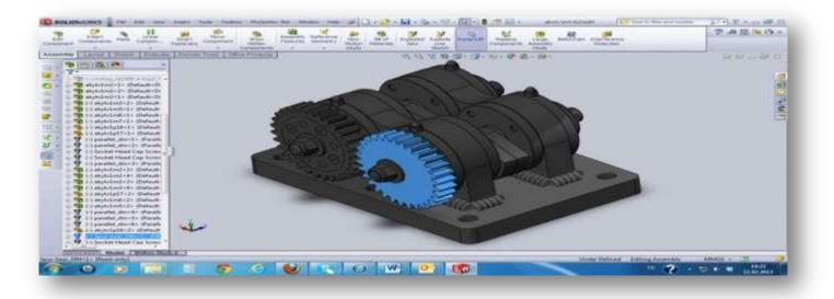
**LOWER VIBRATOR QUANTITY :** 2 x 5,5 kw. SPECIAL MOTOR.// **UPPER VIBRATOR QUANTITY:** 2 x 0,75 kw VIBROMOTOR-OPTIONAL // VIBRATION COOLING CAPACITY : 22.000 Kcal. // **ALL VIBRATIONS:** IT GIVES A MINIMUM VIBRATION TO THE MACHINE BODY USING A SPECIAL DAMPENING SYSTEM.
