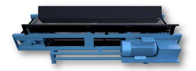
EQUIPMENT TRANSFERS THE THICK MORTAR COMING FROM THE MIXER TO THE THICK MORTAR HOPPER, THIN MORTAR TO THE THIN MORTAR HOPPER. DESIGNED TO MOVE LEFT-RIGHT. MOTOR POWER IS 2,2 KW. MOVES WITH BUTTON ON THE ELECTRIC PANEL IN FRONT OF THE MIXER OPERATOR.
