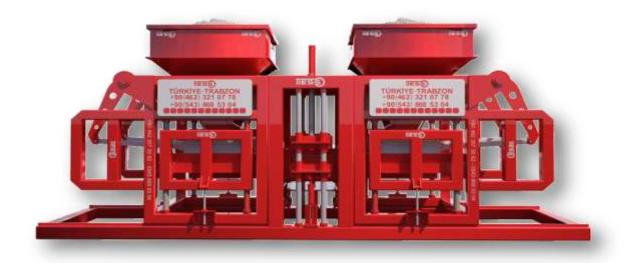
VIBRATION SYSTEM/ STRIKE FORCE ADJUSTABLE/VIBRATION FORCE: 36.500 KG
